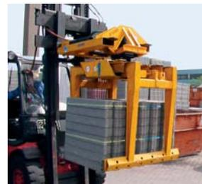
Pinza idraulica montata su carrello STAZ+ET
