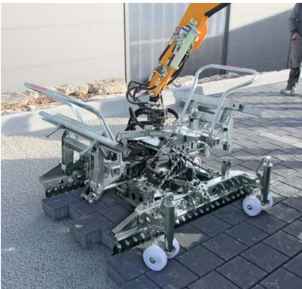
HVZ-UNI-II Pinza idraulica per la posa
