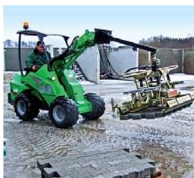
Pinza idraulica per la posa con mini pala
