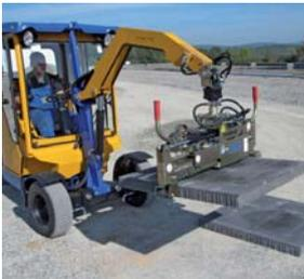
Pinza idraulica per la posa VZ-H-UNI
