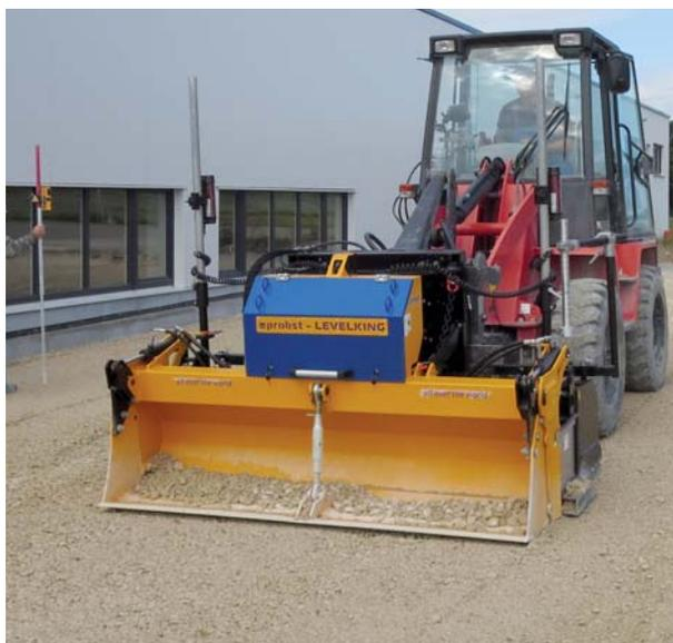
LEVELKING LK per la preparazione dei sottofondi con benna apribile K5
