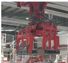
Pinza idraulica per stoccaggio con ganasce con rotazione a 180 gradi
