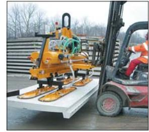
Traversa vacuum VT-6000-D montata su carello elevatore
