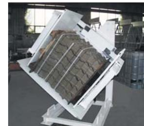
Dispositivo idraulico di rotazione del bancale WT-P
