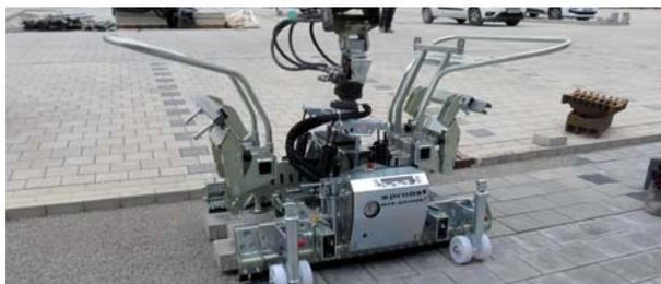
HVZ-GENIUS-II Pinza idraulica per la posa per uso universale con escavatori
