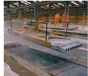
Pinza per posa di lastre per soffitti VZ-D
