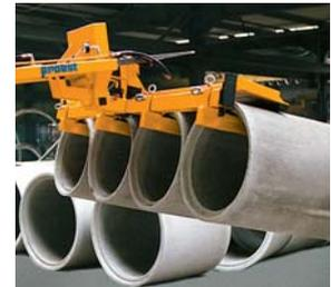
Dispositivo idraulico a rotazione per tubi FUG
