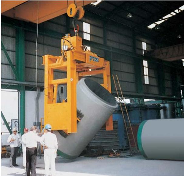
Pinza di ribaltamento per gru a cavalletto per tubi di cemento PWG-R
