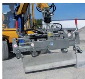
Pinza idraulica per la posa VZ-H-UNI
