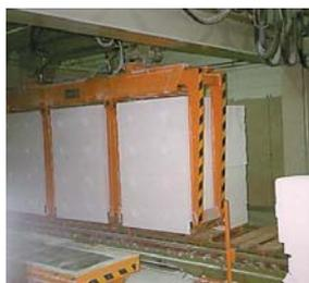
Pinza per accatastamento con sistema idraulico
