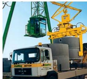
Pinza idraulica per anelli e coni RKUS
