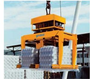
Doppia pinza idraulica STAZ-DZ I fissata a carro ponte
