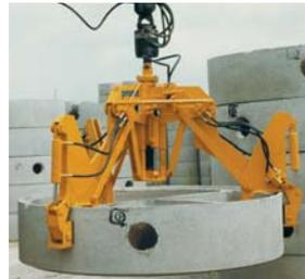
Pinza idraulica per anelli e coni RKG
