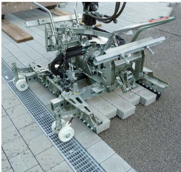
HVZ-ECO Pinza idraulica per la posa
