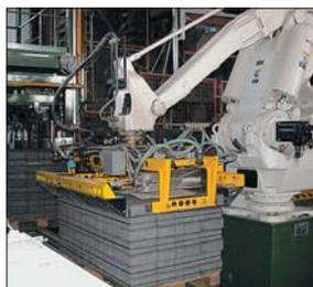
ROBOGRIP P-4 Pinza pneumatica robotizzata
