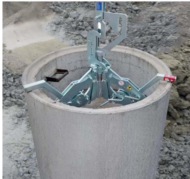
Pinza per coni e pozzetti SVZ-UNI
