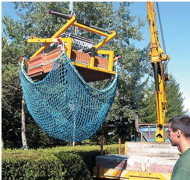
Pinza per elementi per tetti con rete di protezione DEZ-UNI
