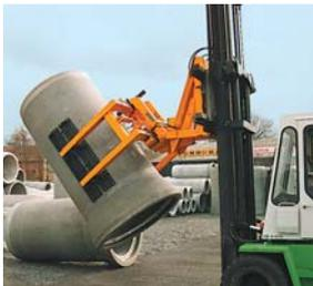
Dispositivo a rotazione per tubi in cemento UG
