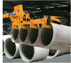
小型管道旋转装置 FUG
