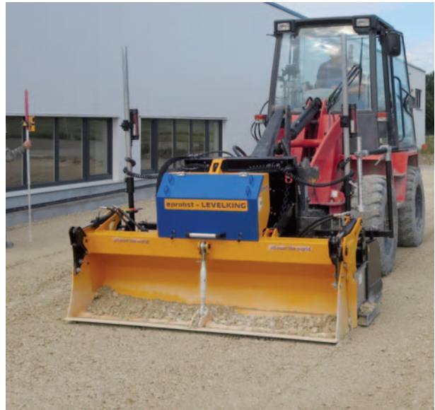
带有折叠式铲斗KS的找平机 LEVELKING LK
