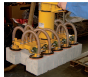
沟槽制品所用的多吸盘式铺装工具
