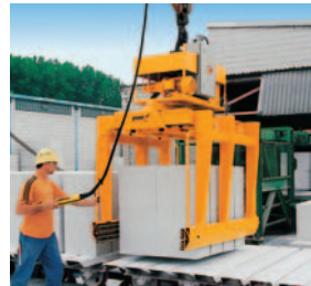
安装在龙门架上的灰砂砖夹具 PKZ-KS
