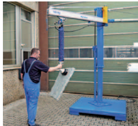
VACUSPEED VXS 软管式真空吊具
