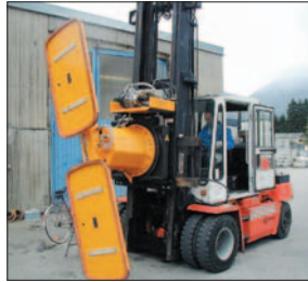
叉车用真空旋转装置 VACUSPEED VXS
