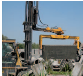
用于混凝土制品的叉车式抱夹 STAZ
