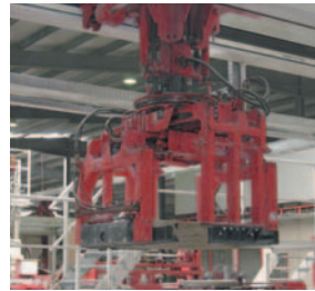
可旋转 180 度的液压式码垛机
