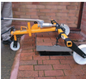
竖井顶盖液压式提升器 SDH-H-15
