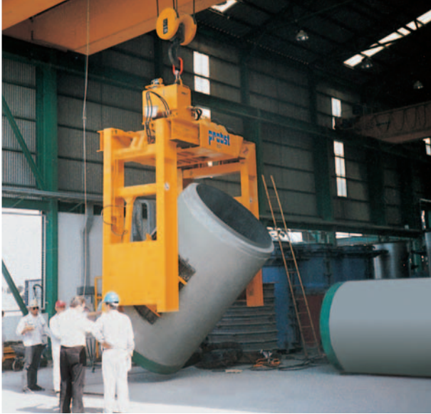
龙门吊用旋转式管道抱夹装置 PWG-R
