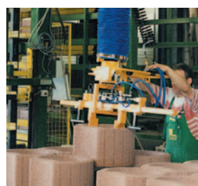
带有气动夹具的软管式真空提升器 ASZ-P
