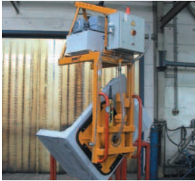
带180度旋转装置的真空提升器 ESP-SW-P
