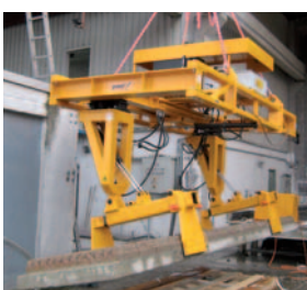
隔音墙安装设备
