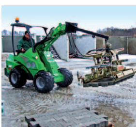
小型装载机上的液压铺装夹具
