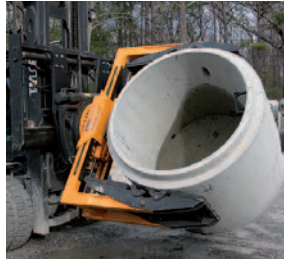
混凝土基座翻转装置 WG-S
