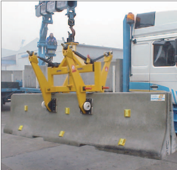
混凝土隔离栏夹具 BSZ-KH-6.0
