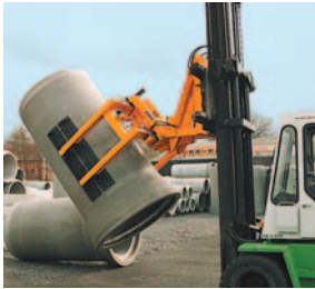
混凝土管道翻转装置 UG
