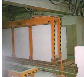
带有液压分离装置的码垛机 STAZ
