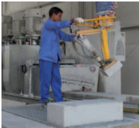
带有气缸的旋转真空吸盘 ESP-SW-P
