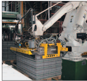
气动机器人码垛机 ROBOGRIP P-4
