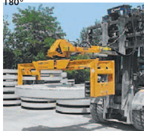
Aanbouwkraan STAZ op heftruck voor afdekplaten
