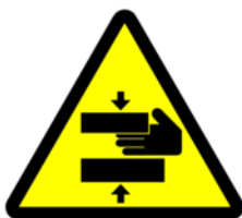
Avertissement blessure à la main due à un écrasement 2904 .0396
